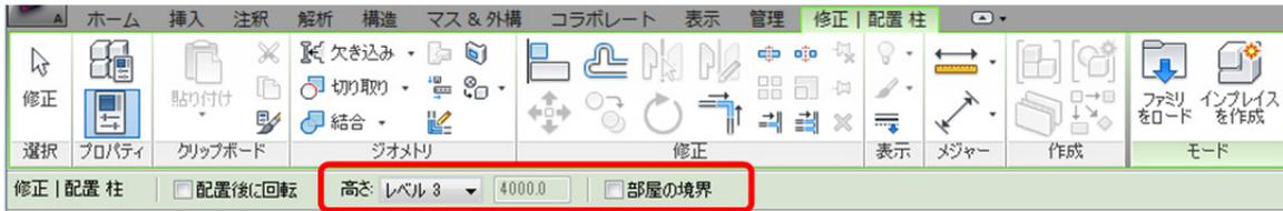
3. 柱の中心が基点になっています。下図のように、X0 通り～X3 通りと Y2 通り～Y5 通りの交点（近接点と近接点）に芯振りで配置します。
